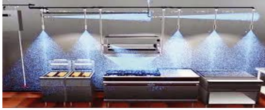
Resim-5.5. Mutfakta uygulanan sabit yangın söndürme sistemi-1
