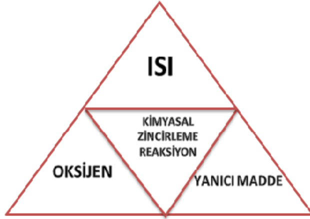
Şekil-2.2 Yangın dörtlüsü
