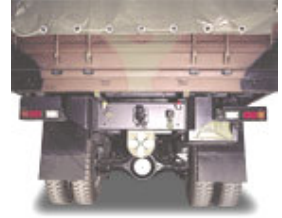
NATO standartlarında karartma, aydınlatma, çeki kancası
