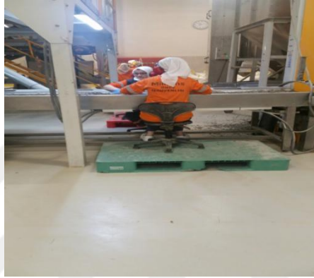
Şekil 2. 15: Kavurma hattında uygun olmayan oturma ekipmanı
