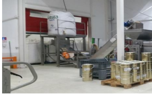
Şekil 2. 19: Hammadde besleme ve eleme ünitesi
