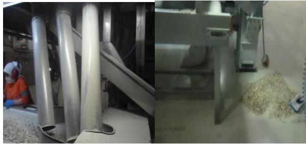
Şekil 2. 38: Kavurma ünitesinde toz birikimi
