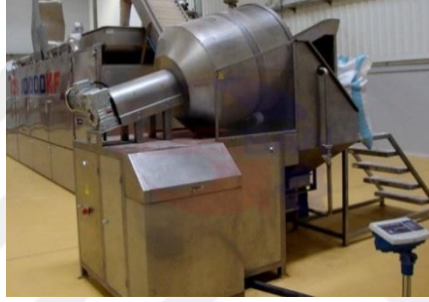
Şekil 2. 12: Kavurma makinesi opsiyonları tuzlama ve şerbet ünitesi
