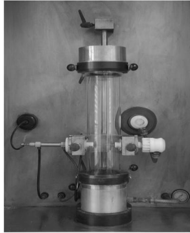
Şekil 4.8. Minimum Tutuşturma Enerjisinin (MTE)' nin belirlenmesi için MIKE 3 Aparatı (Abbasi ve Abbasi, 2007)
