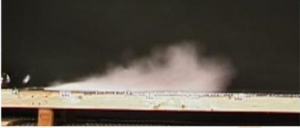
Şekil 4.4. Toz Tabakası Üzerine Hava Üflemesinden Üretilen Mısır Nişastası Toz Bulutu (Zalosh, 2011).
