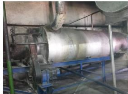
Şekil 7.9. Tesis □ (Uşak) Döner Fırın
