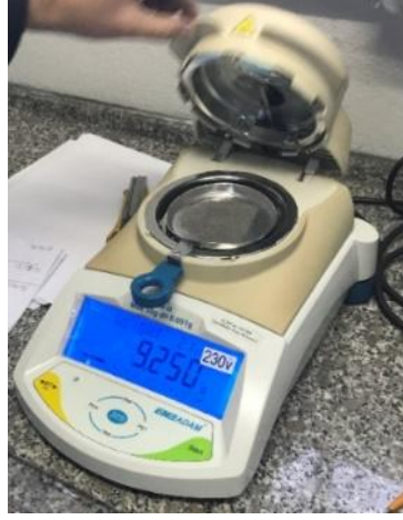
Şekil 7.25. 0.01 Gram Hassasiyette Elektronik Terazı
