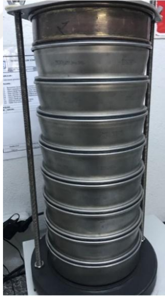
Şekil 7.26. Titreşimli 500 \times 45 Mesh Elek
