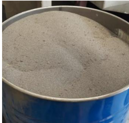
Şekil 7.15. Tesis 2 (Manisa) Kumlama Ünitesinden Yan Ürün Olarak Çıkan Alüminyum Alaşım Tozu
