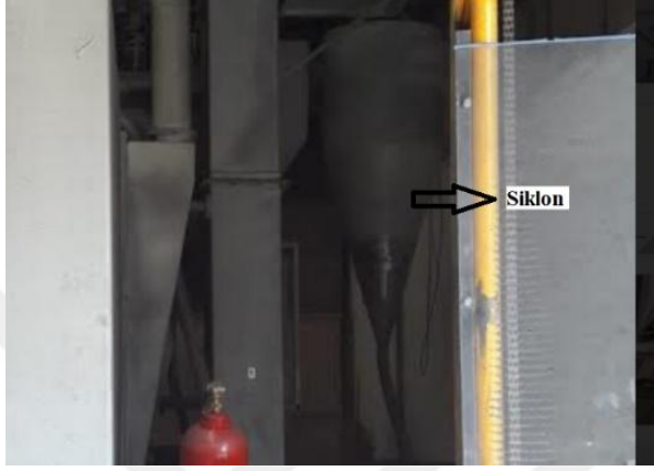
Şekil 7.22. Tesis 2 (Manisa) Kumlama Sistemi – Siklon
