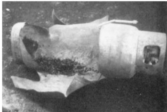
Şekil 2.9. Harici Bir Yangına Maruz Kalmış LPG Silindiri (NFPA 921, 2017)
