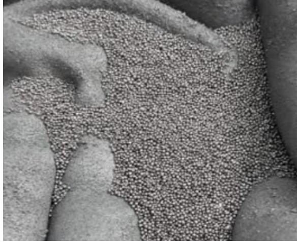
Şekil 7.13. Tesis □ (Manisa) Kumlama Ünitesinde Kullanılan Demir Bilyalar
