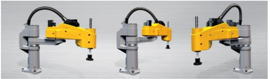
Resim 2. 4 Dört Eksenli 8 kg. Taşıma Robotu
