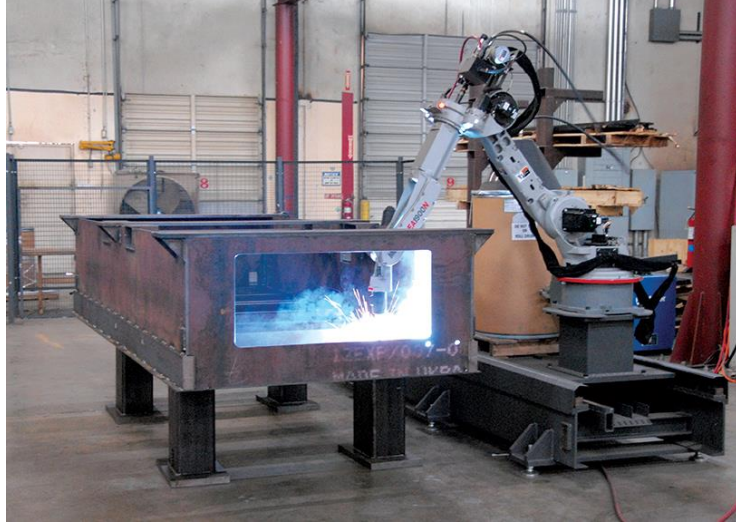
Resim 4. 28 Çukur Kaynağında Erişim Arttırımı için Slider Kullanımı
