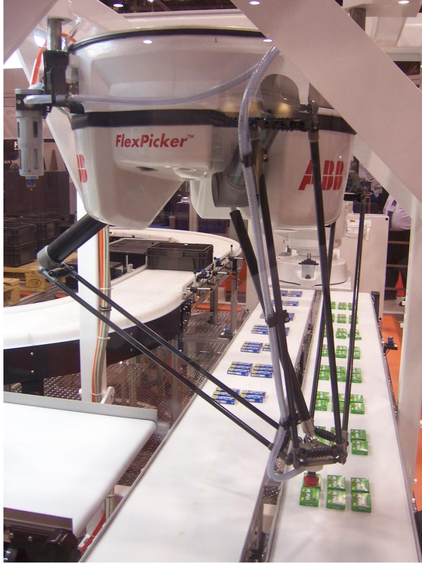
Resim 2. 3 ABB Flexpicker Sakız Fabrikası Paketleme Uygulaması
