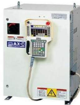
Resim 4. 7Altı Eksenli Kaynak Manipülatorü Kontrol Ünitesi
