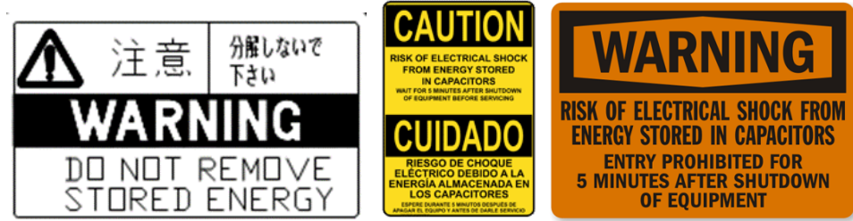
Şekil 4. 35 Depolanmış Elektrik Enerjisi Uyarısı
