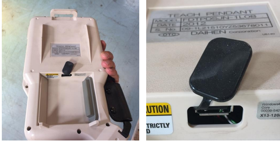
Resim 4. 13 El Terminali Arkasında Yedekleme için USB Arayüzü
