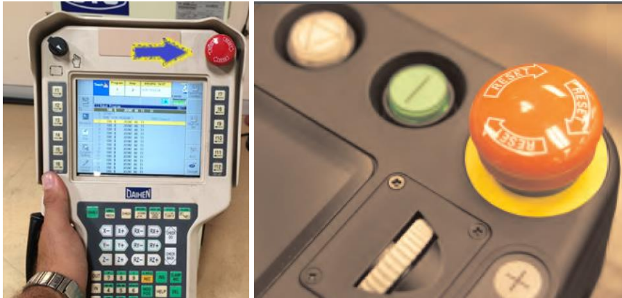
Resim 4. 9 El Terminalinde Acil Durdurma Butonu
