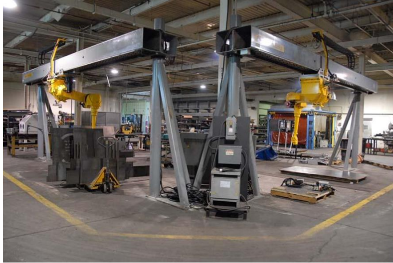
Resim 4. 25 Gantry Kaynak Robot Sisteminde Yer Kazancı
