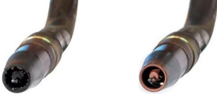
Resim 4. 21 Torç Temizlenmeden Önce ve Temizlendikten Sonra Görünüşü
