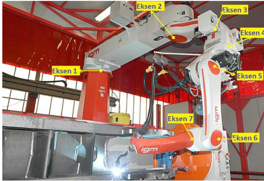
Resim 4. 38 IGM Firması Tarafından Standart Olarak Satılan 7 Eksenli Robot
