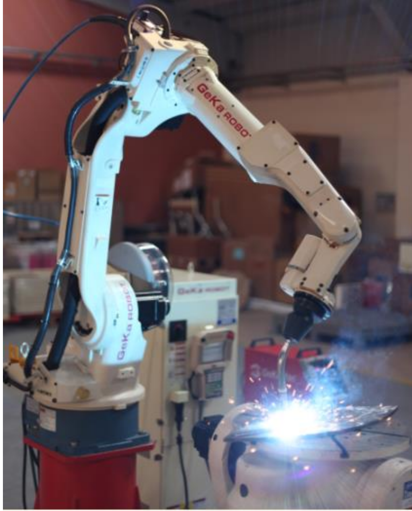
Resim 4. 40 İçten (Entegre) Kablolü Kaynak Robotu
