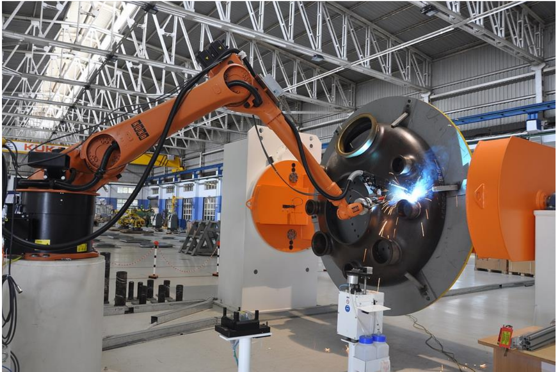
Resim 3. 4 Lazer Kaynağı ile Dairesel Kaynak Üretimi
