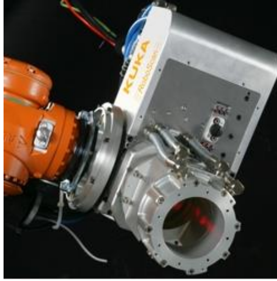
Resim 3. 3 Lazer Kaynağı Gerçekleştiren Lazer Başlığı
