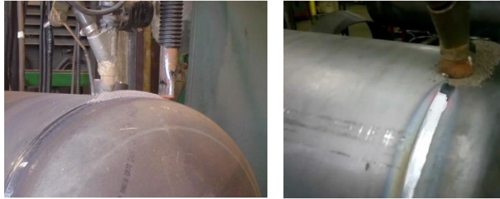
Resim 5. 2 Toz Altı Kaynak ile LPG Tankı Yan Kapama Sac Kaynağı
