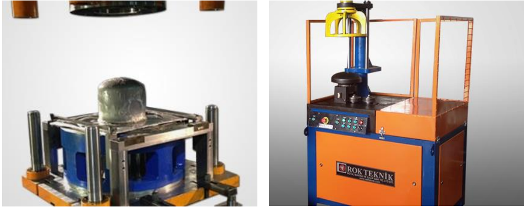
Resim 5. 6 LPG Tankı İmalatı Sac Şekillendirmede Kullanılan Hidrolik Pres
