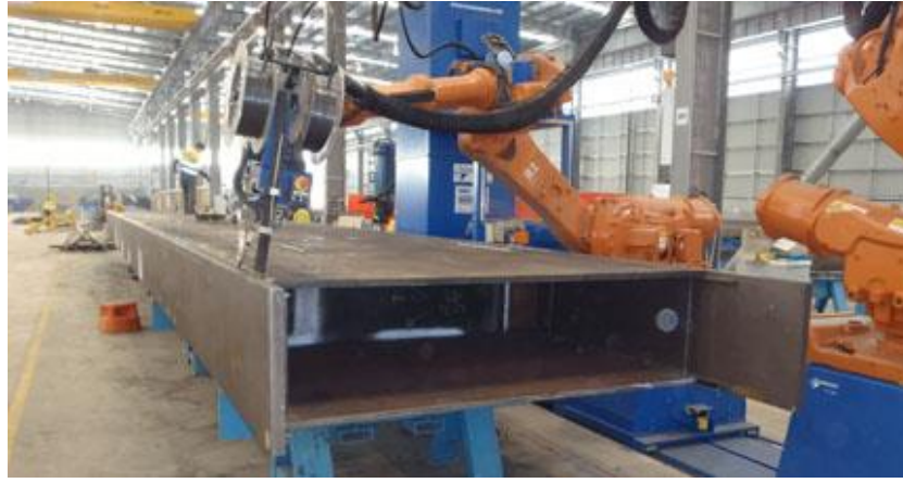
Resim 3. 1 Robot ile Toz Altı Kaynak Uygulaması
