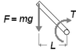
Şekil Ek-D 1 Tork'un Kuvvet ve Mesafe Bileşenleri Üzerinde Gösterimi
