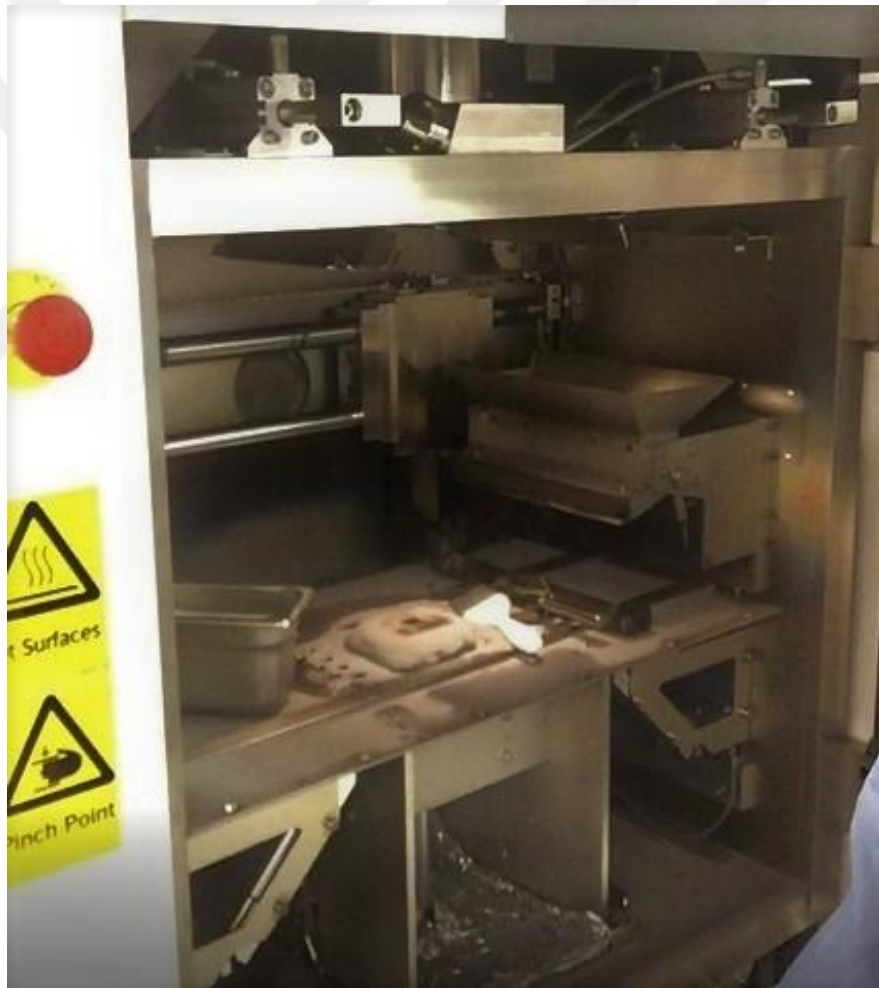
Şekil 5. 28. Numunenin toz yatağından çıkarılma aşaması
