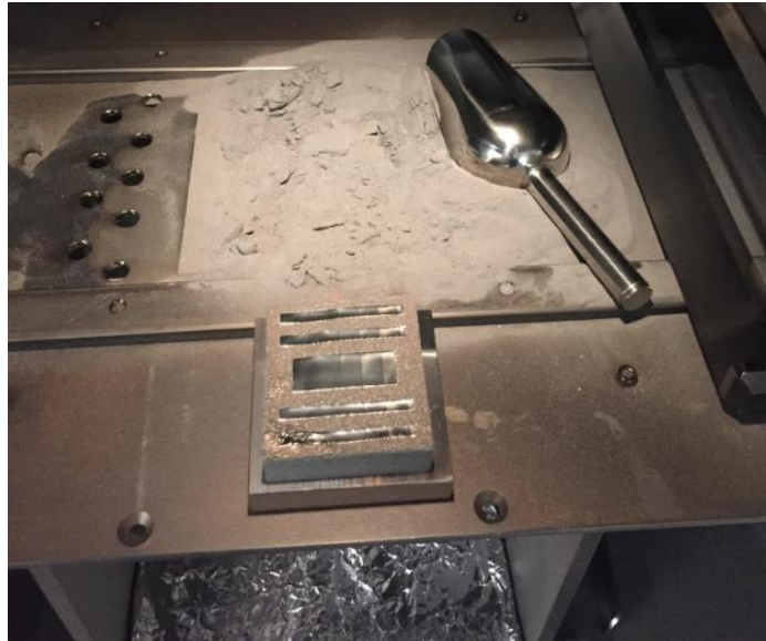
Şekil 5. 29. Numunelerin toz yatağından çıkarılması
