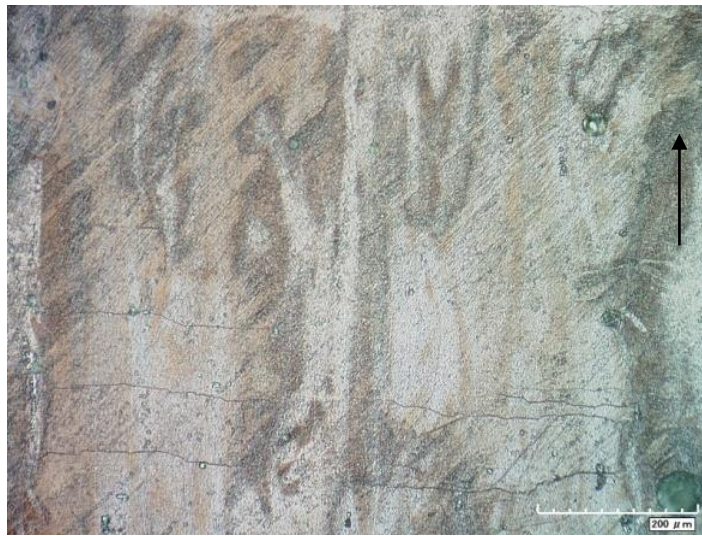
Şekil 6. 5. Ni-Ti alaşımının enine kesit numunesinin 70x büyütmedeki OM mikroyapı görüntüleri
