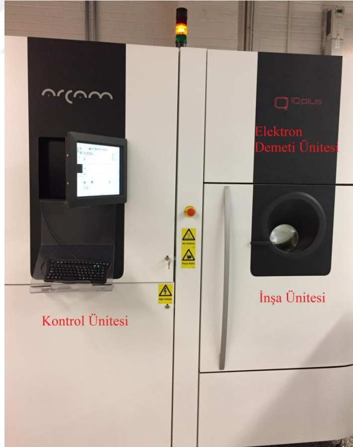
Şekil 5. 9. Ni-Ti üretiminde kullanılan Q10Plus cihazı dış görünüşü ve üniteleri
