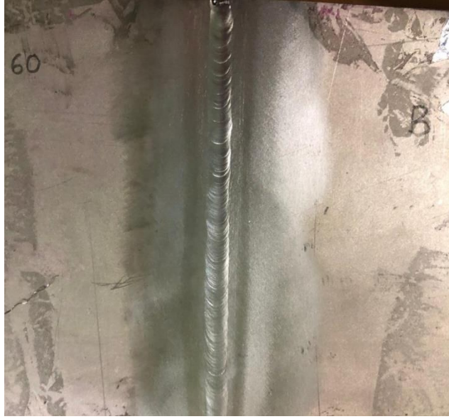
Şekil 3.7: 60 Amperde Kaynak Yapılan 'B' Parçası
