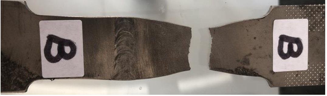
Şekil 4.5: 'B' Parçası Çekme Test Sonucu Görünümü
