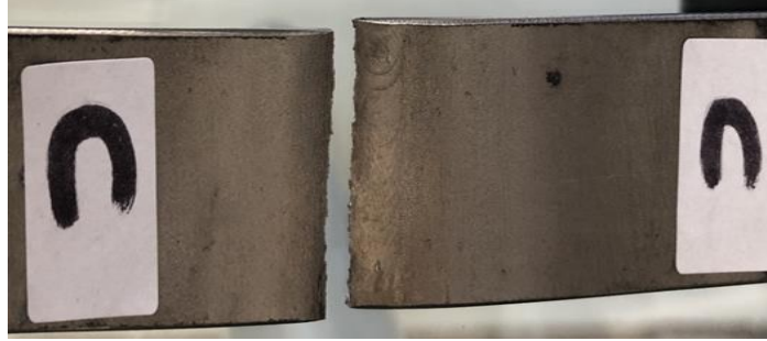
Şekil 4.3: 'C' Parçasının Eęme Testinden Sonraki Görüntüsü
