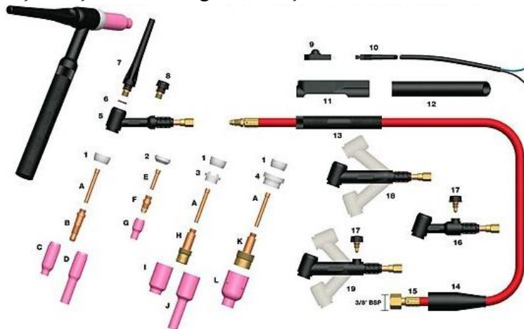
Şekil 2.12: TIG Kaynak Torç Parçaları (URL-11, 2018)
