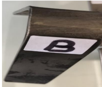
Şekil 4.2: 'B' Parçasının Eğme Testinden Sonraki Görüntüsü
