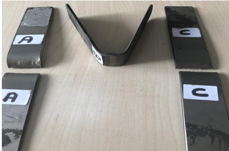
Şekil 3.12: Parçaların Eğme Testinden Sonraki Görüntüleri
