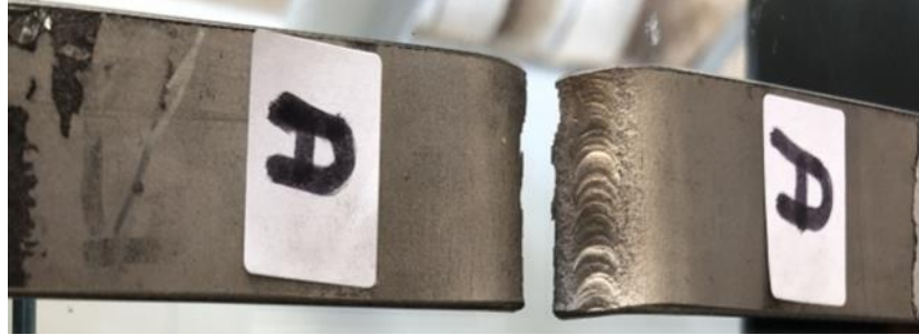
Şekil 4.1: 'A' Parçasının Eğme Testinden Sonraki Görüntüsü
