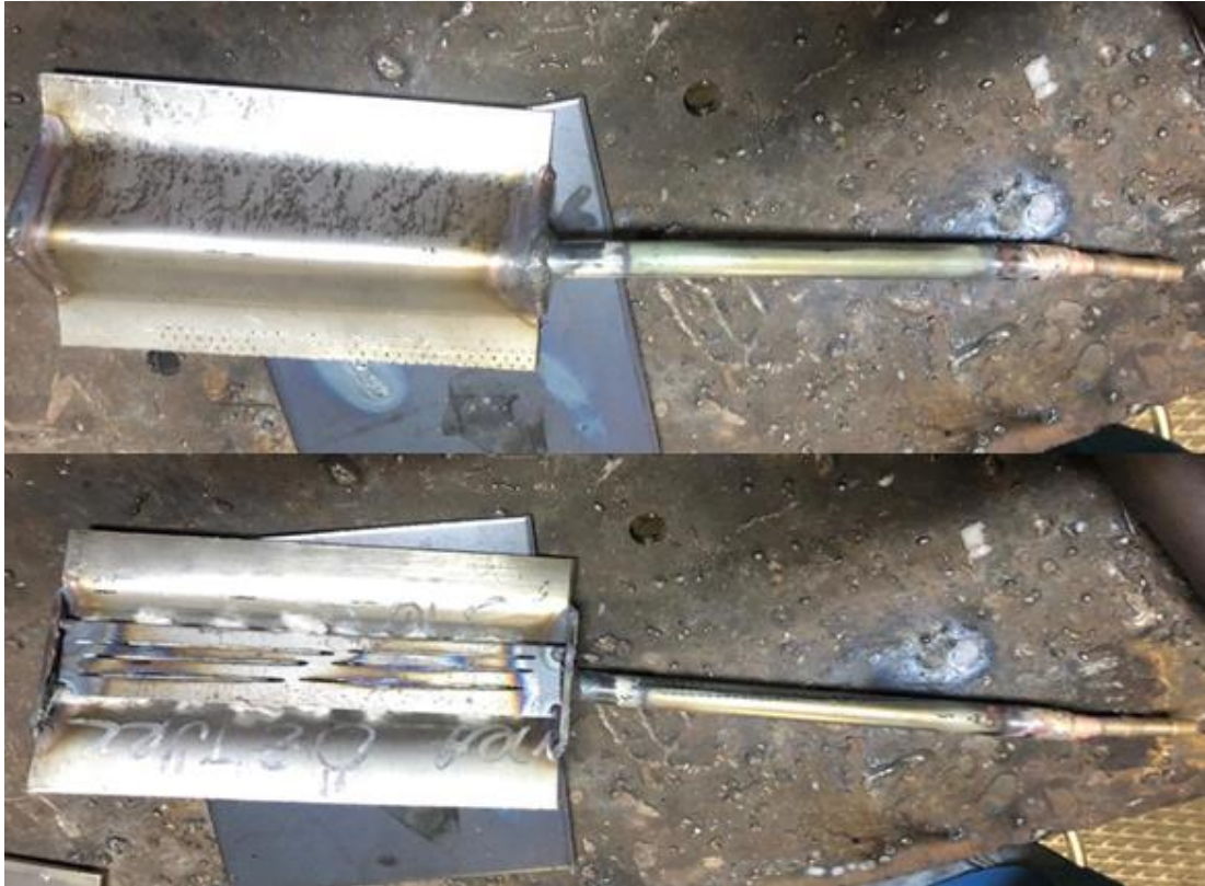
Şekil 3.4: Kök Koruma Gazı için Yapılan Altlık
