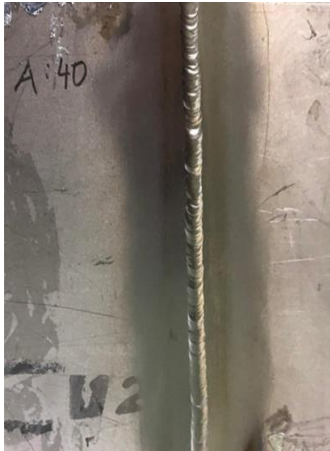
Şekil 3.6: 40 Amperde Kaynak Yapılan 'A' Parçası
