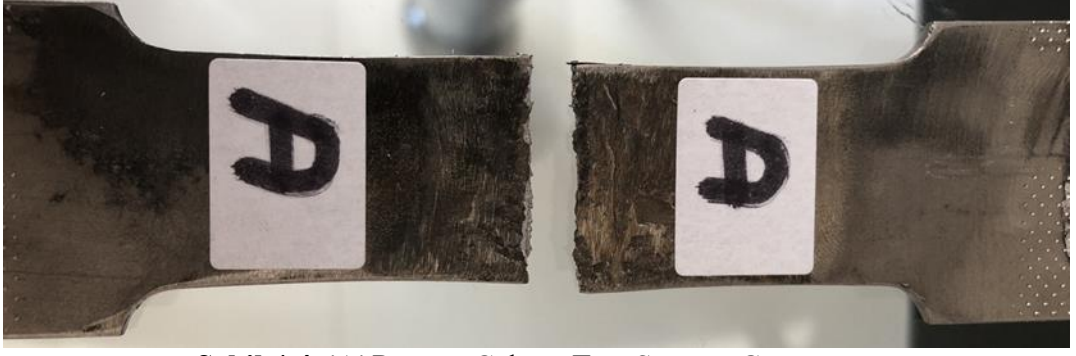
Şekil 4.4: 'A' Parçası Çekme Test Sonucu Görünümü
