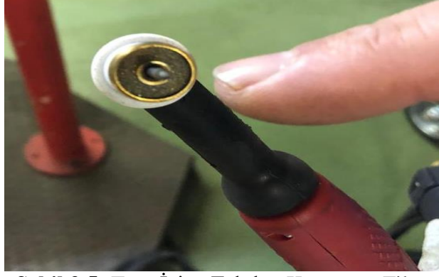
Şekil 3.5: Torç İçine Takılan Koruyucu Filtre
