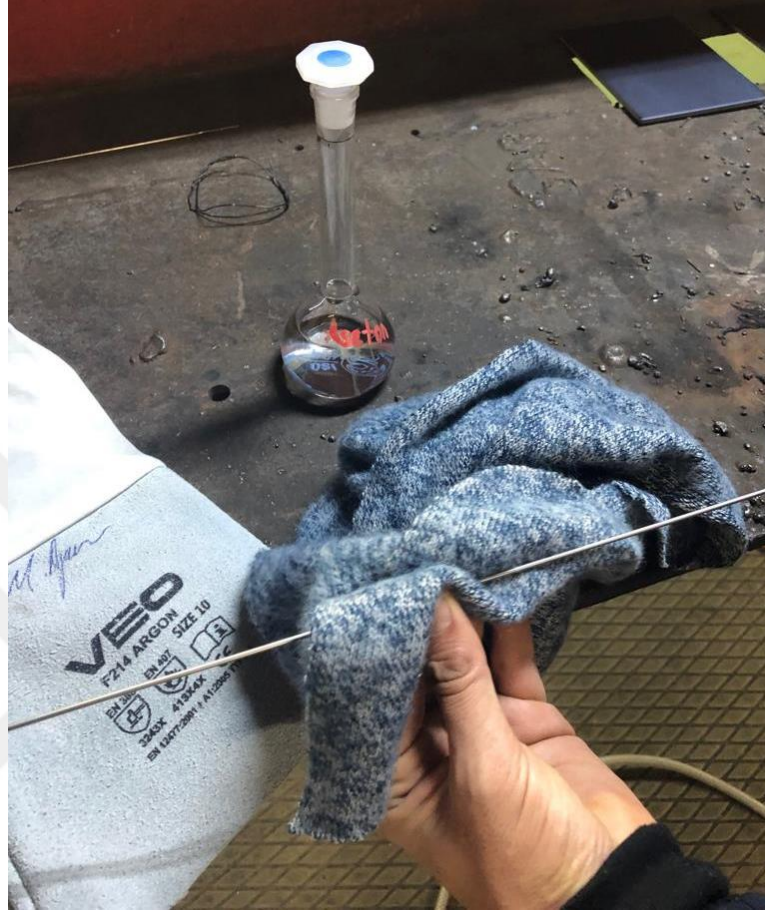
Őekil 3.2: Aseton ile Temizlenen Ana Paralar ve İlave Tel
