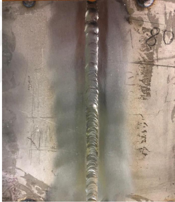
Şekil 3.8: 80 Amperde Kaynak Yapılan 'C' Parçası
