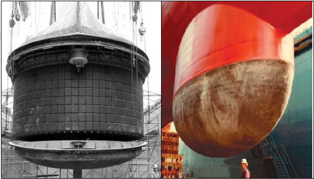
Şekil 3.3 : Kauçuk Kaplama Sonar Transdüseri ve Kompozit Sonar Domu
