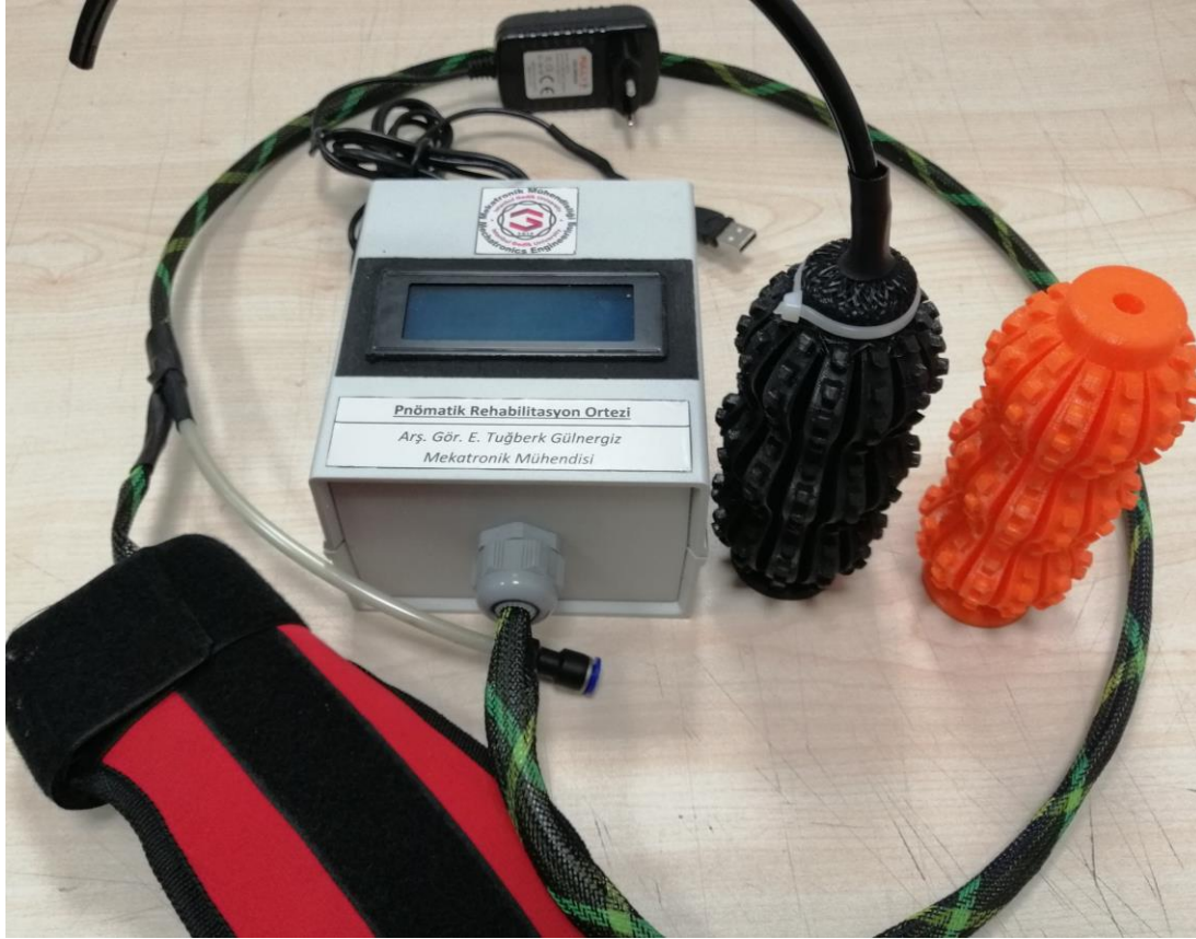
Şekil 4.1 : Yapay Kas Pnömatik Rehabilitasyon Ortezi ve Kontrol Sistemi
