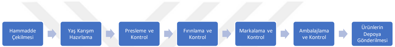
Şekil 2.9: Kaynak Elektrotunda Çekirdek Tel Üretim Şeması
