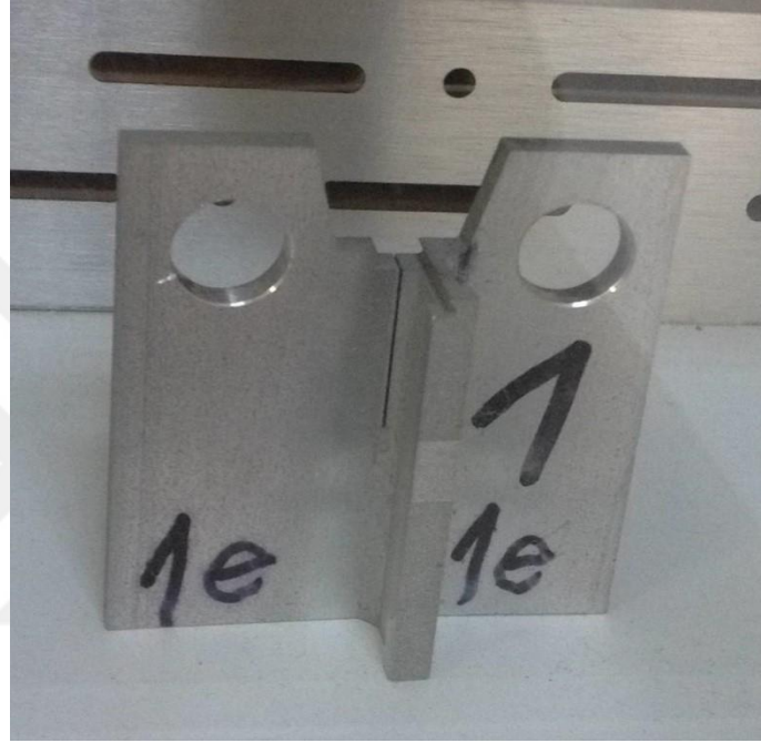
Şekil 3.12: CTOD Testine sokulmuş deney numunesi
