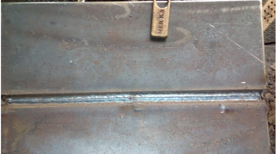
Şekil 3.10: GeKa Tempo B65 bazik elektrotu ile yapılan deney çalışması
