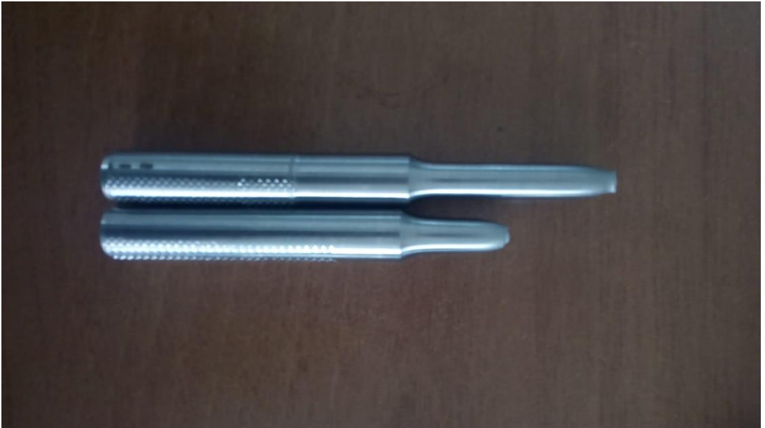
Şekil 3.11: Çekme testine sokulan deney numunesi
