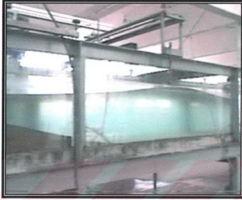
Şekil 4.4 Üretilen solitary dalganın hareketi ( t = 9,68 s)
