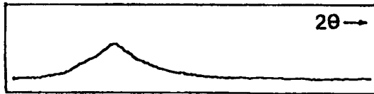
Şekil 4.1.,Döküm yasında ki Fe_{78}B_{13}Si_9 metalik cam şeritinin X-Işını paterni
