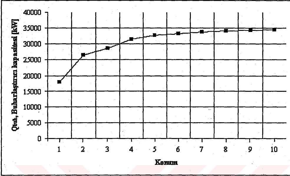
Şekil 4.7 Konum- Buharlaştırıcı Kapasitesi Grafiği
