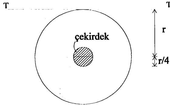
Şekil 2.5 Daire kesitin çekirdek alanı
