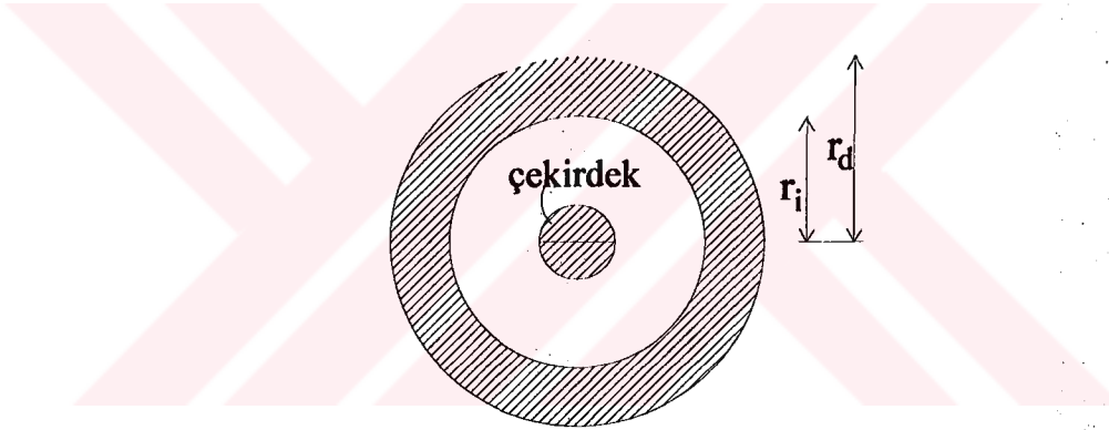
Şekil 2.6 Halka kesitin çekirdek alanı
