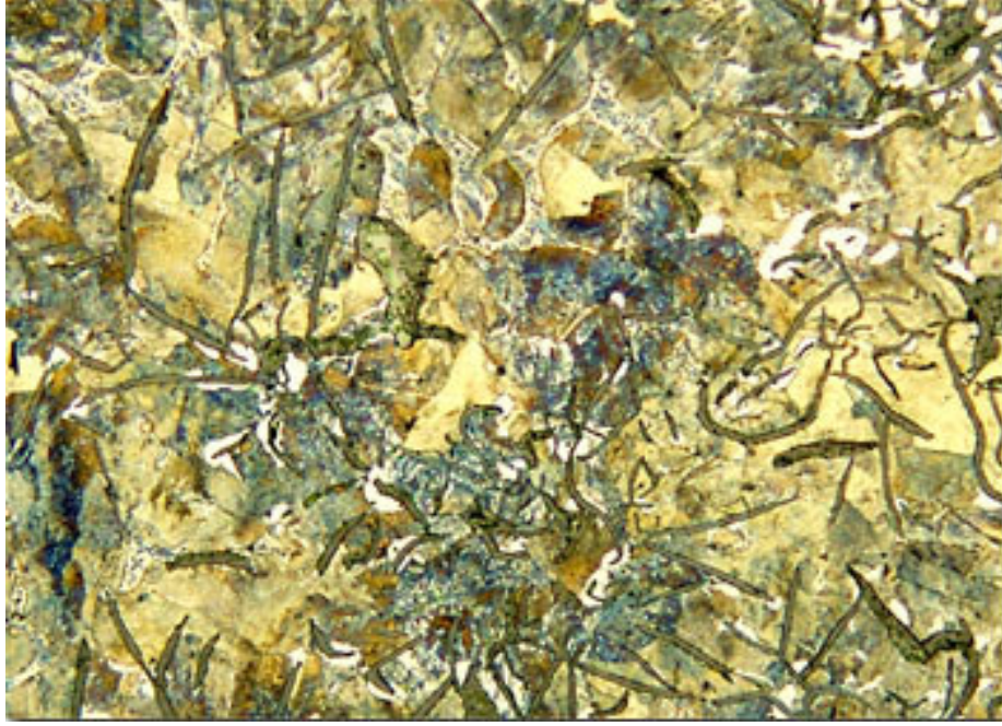
Şekil 2.10 Gri Dökme Demirin İç Yapısı
