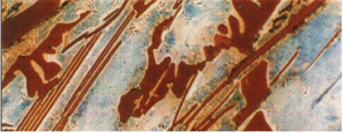
Şekil 2.12 Beyaz Dökme Demirin İç Yapısı
