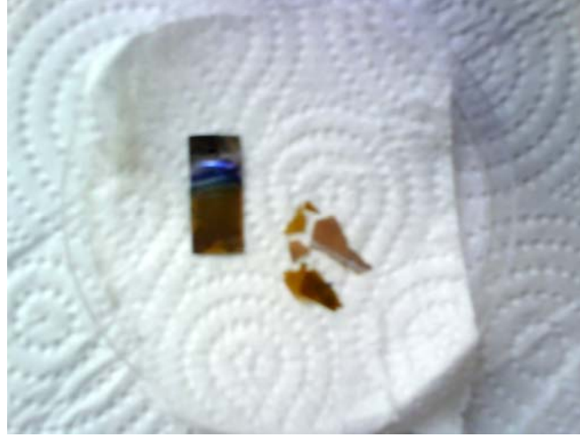
Şekil 6.31. Etilen Glikol içeren çözeltide 17 saat süre ile anodize edilen titanya nanotüpler ve yüzeyden kırılarak kalkan \text{TiO}_2 nanotüp tabakası.
