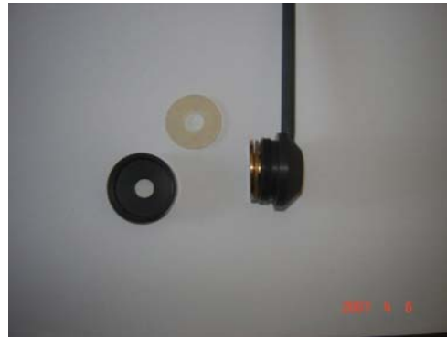
Şekil 6.2. Anodizasyon hücresi ve numune tutucunun görüntüleri.
