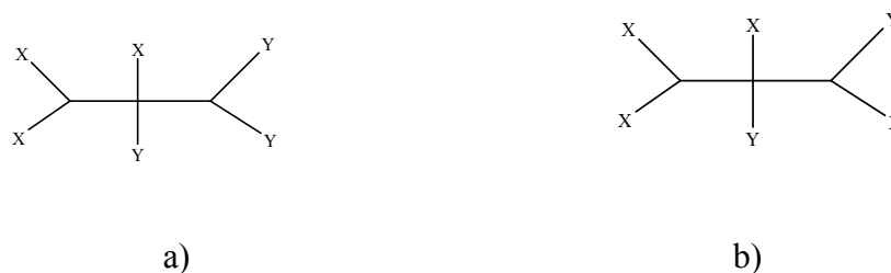
Şekil 2.16. Hekzaklorosiklotrifosfazatrien (trimer)'in a) geminal trisüstitüe bileşikleri b) geminal olmayan trans -di ve tetra süstitüe türevleri
