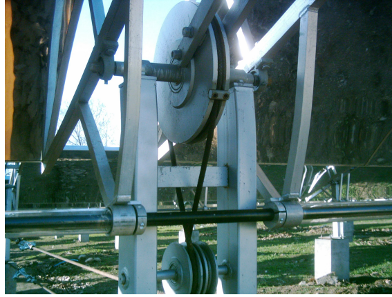
Şekil 4.8. Kollektör Tahrik Sistemi. Makara ve Çelik Halat.
