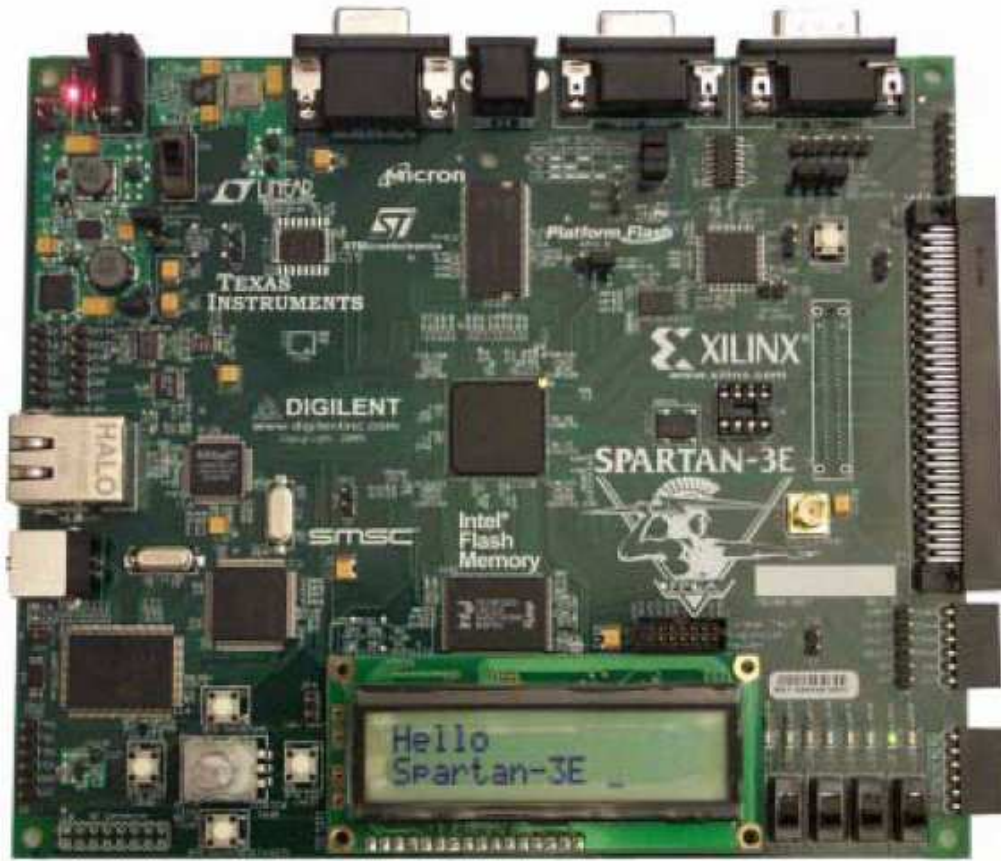
Şekil-12 : Xilinx Sparten 3E Starter Kit
