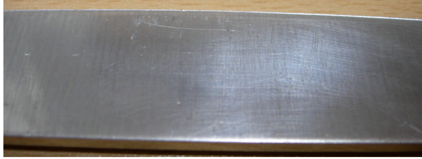
Şekil 4.22 Hadde yönüne dik kesilmiş numune
