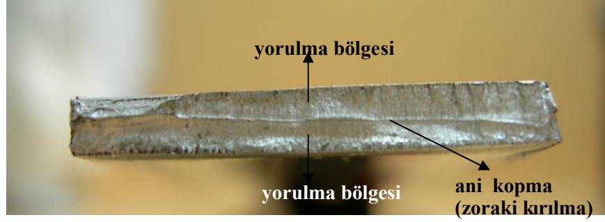
Şekil 4.31 1100-H14 alüminyum numunesinin yorulma kırılması yüzeyi
