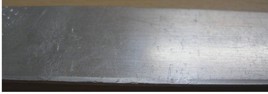
Şekil 4.21 Hadde yönüne paralel kesilmiş numune
