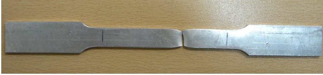
Şekil 4.15 ASTM E 8M – 04 ‘e göre hazırlanmış alüminyum çekme numunesi
