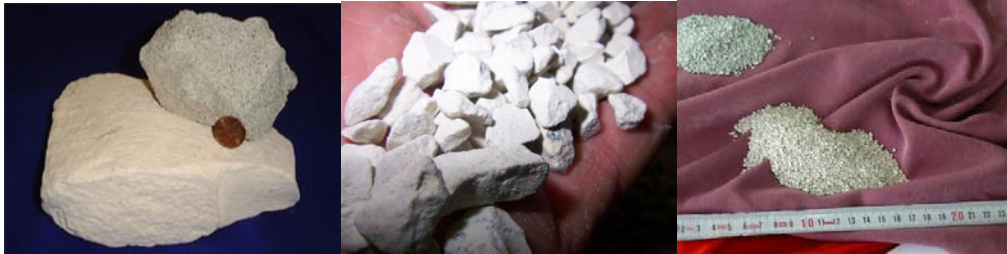
Şekil 4.4. Doğal Zeolit: Maden cevheri ve değişik tane boyutlu ürünler
