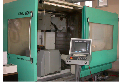
Şekil 7.1. DECKEL MAHO DMU 60 P beş eksen işleme merkezi.
