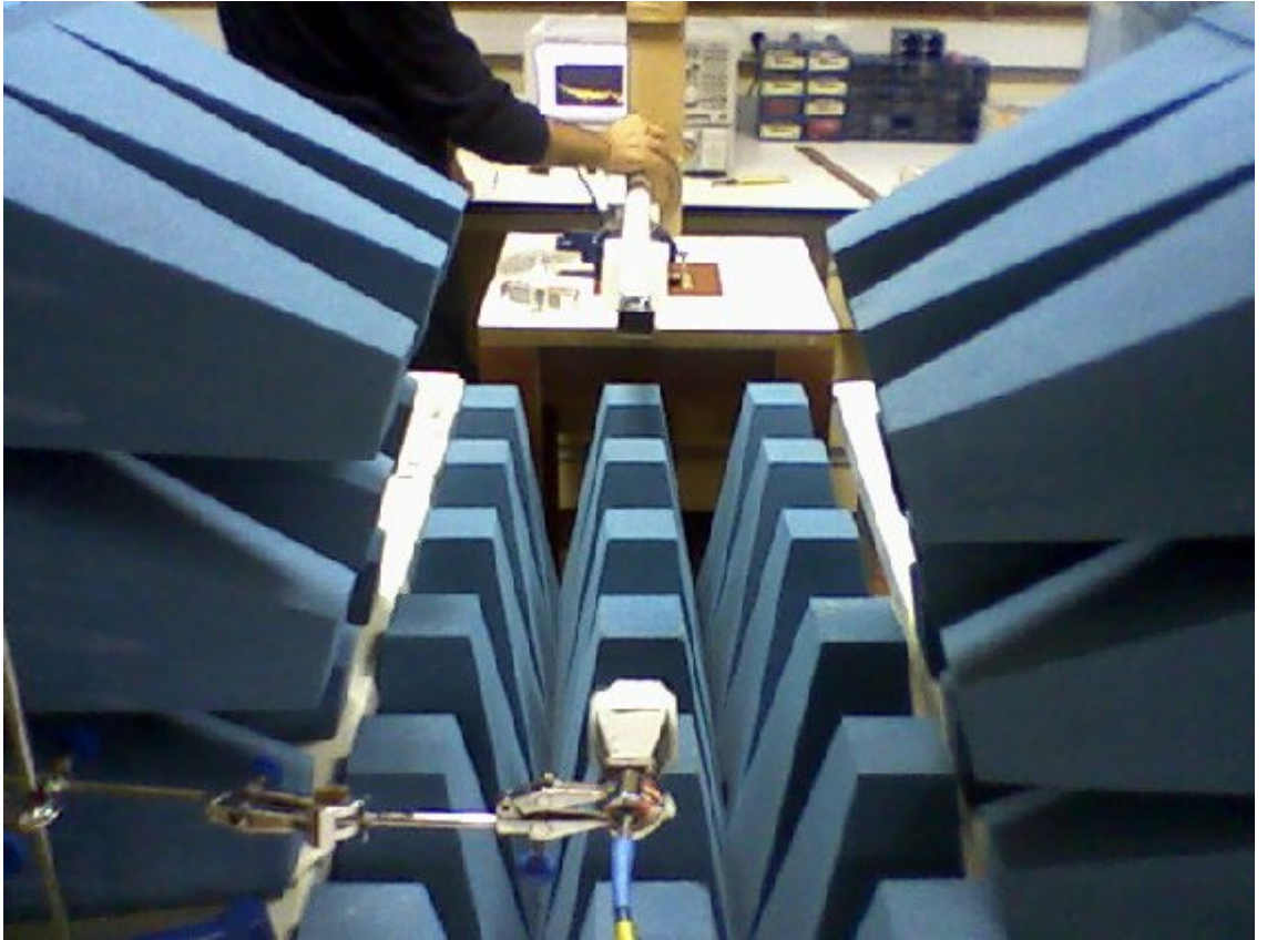
Şekil.6.3. Yarı Yansız Kabinde Deney Düzeneđi 2
