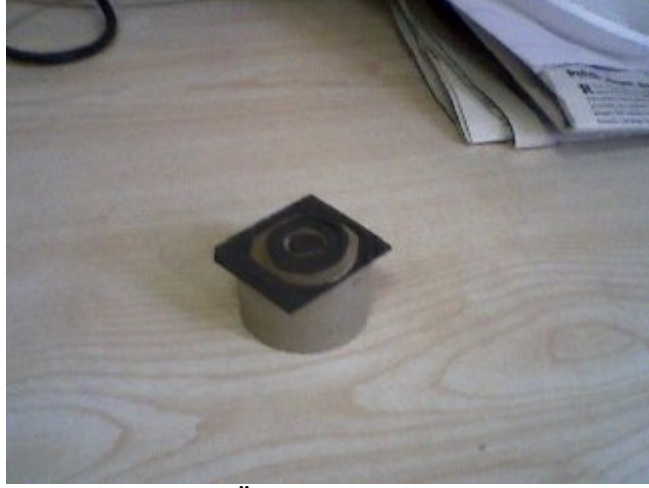
Şekil.4.3.Ortası Dolu Parafin Önünde Radar Soğurucu Malzemeli Tampon (ODPRAM)
