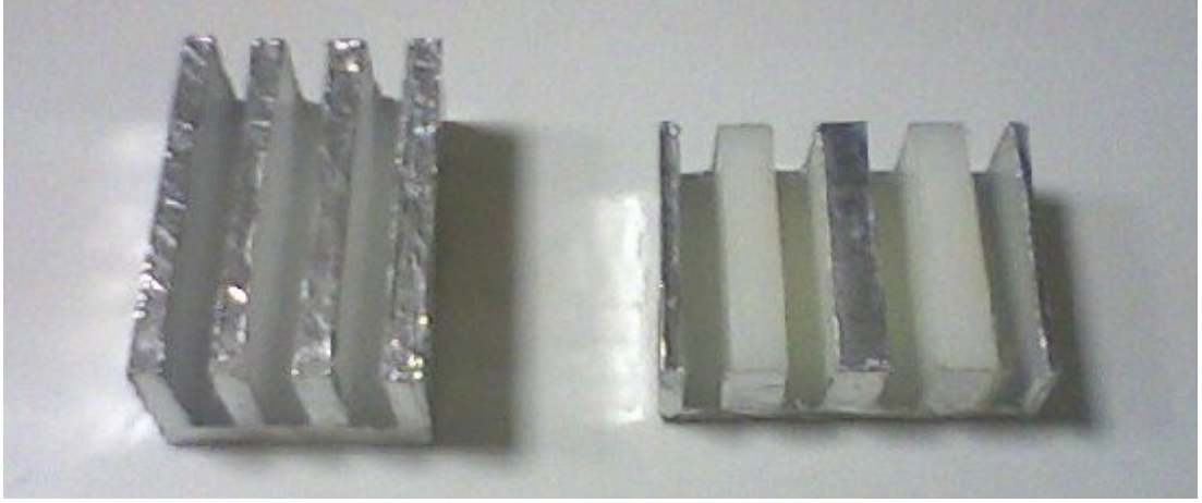
Şekil.4.8.Yivli Ekranlanmış Polietilen MDKO Tamponlar
