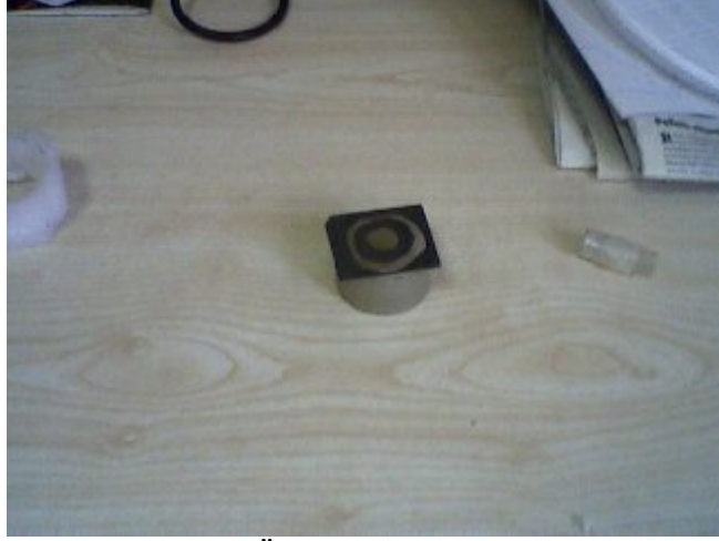
Şekil. 4.4.Ortası Boş Parafin Önünde Radar Soğurucu Malzemeli Tampon (OBPRAM)
