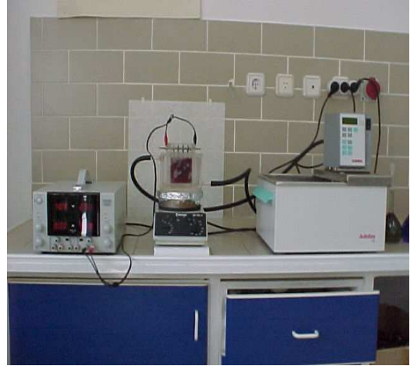
Şekil 4.1. Kesikli EC proses çalışmalarında kullanılan deney düzeneği
