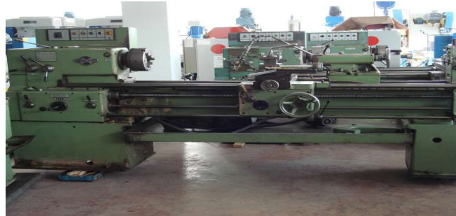
Şekil 8.2. Taksan marka 12 kw motor gücüne sahip torna tezgahı.
