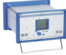
Şekil 8.6. KISTLER 5070A11100 tipi amplifikatör.
