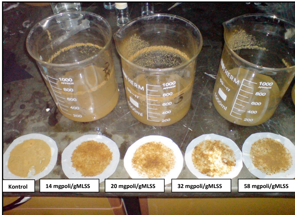
Fotoğraf 4.2. Polielektrolit deneyinde kullanılan çamurların klasik filtrasyon deneylerinden sonra membran yüzeyinde biriken çamurun oluşturduğu kek tabakalarının görünümü.
