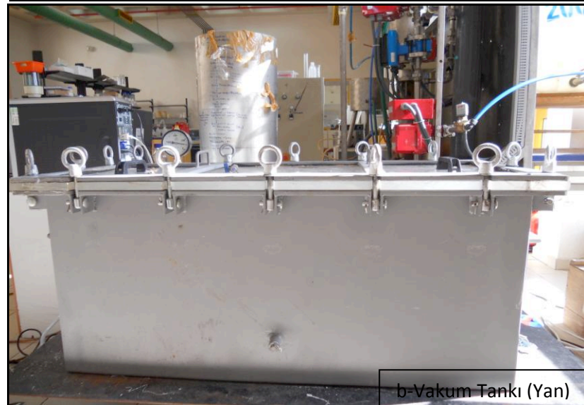
Fotoğraf 3.2. Deneylerde kullanılan batık membran modülleri ve vakum tankının resimleri.
