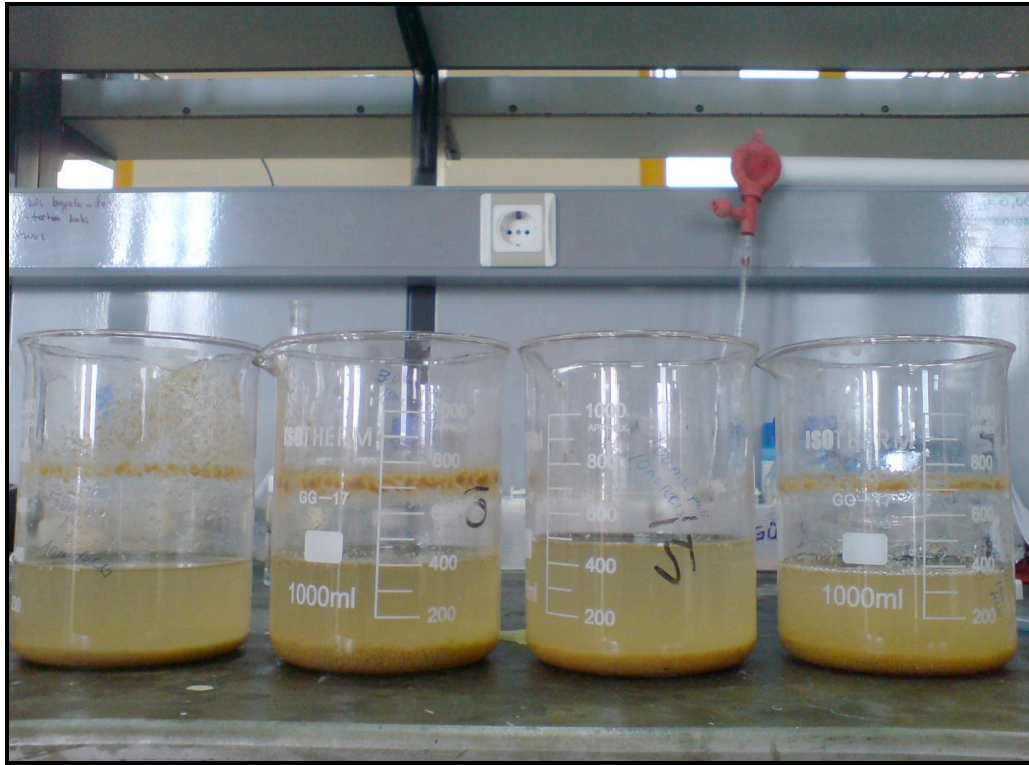
Fotoğraf 4.1. Uygun katyonik polielektrolit bulunması için yapılan deney düzeneğinin gösterimi.
