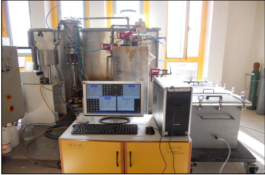
Fotoğraf 3.3. Batık membran filtrasyon deneyleri çalışma düzeni.
