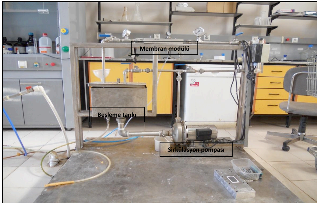
Fotoğraf 3.4. Deneylerde kullanılan çapraz akış filtrasyon sistemi.
