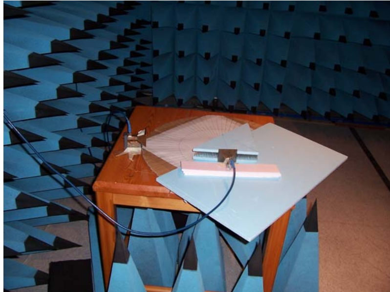
Şekil 3.12. Nikel telli Fotonik Kristalle Kırılma Açısı Ölçümleri (Statik Manyetik Alansız ortamda).
