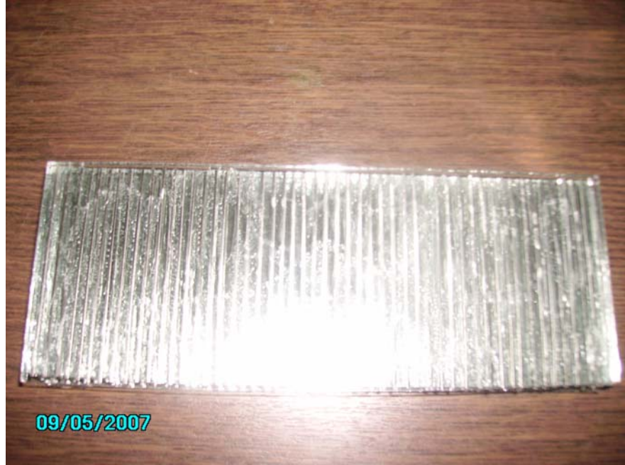
Şekil 3.7. Mumetal şeritlerden yapılmış dikdörtgen fotonik kristal resmi.
