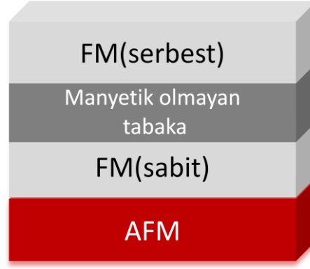
Şekil 4.2 Manyetik kayıt teknolojisinde kullanılan GMR ve TMR yapısını oluşturan “spin vanası” sistemi.
