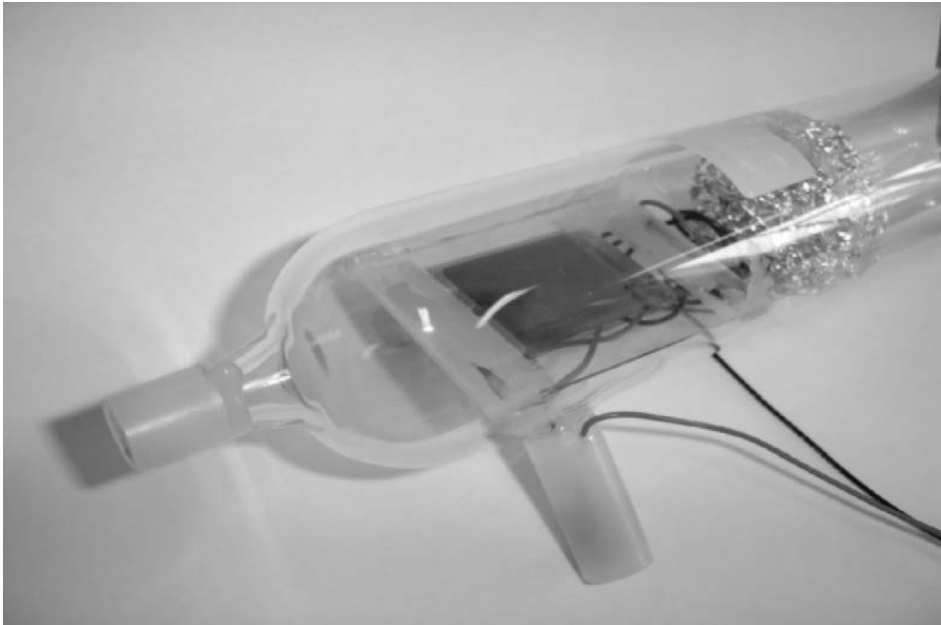
Şekil 2.7. Güneş pillerinde cam kaplama tekniğinin gösterimi [43].
