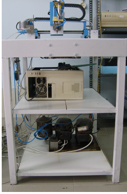
Şekil 2.11. Mozaik dizme robotu elektronik ve pnömatik elemanları
