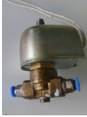
Şekil 2.30 Vakumlama sisteminde kullanılan selenoid valf
