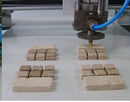
Şekil 4.17 Dikdörtgen mermerlerin yerleştirilmesi
