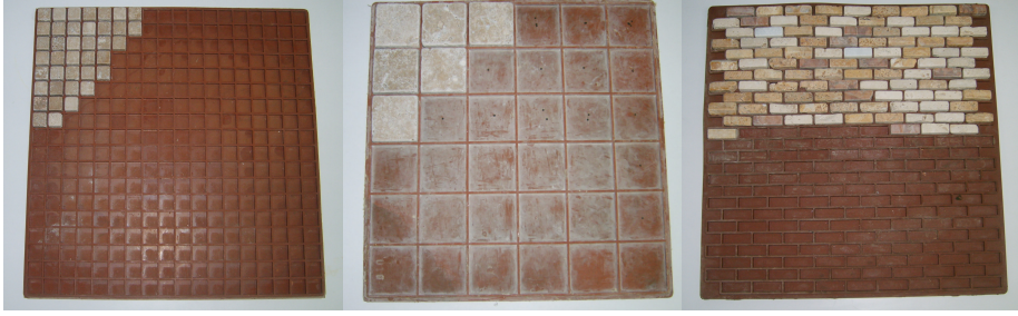
Şekil 1.8 Mozaik diziminde kullanılan kalıplar
