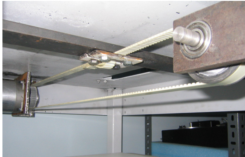
Şekil 2.7 Y eksenindeki hareket mekanizması
