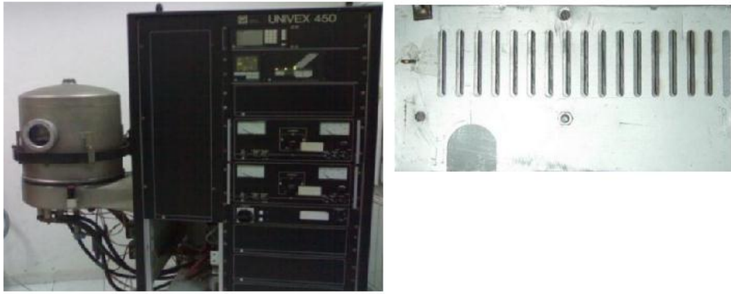
Şekil 3.4. Vakum buharlaştırma sistemi (sol) ve kullanılan maskenin görüntüleri (sağ)
