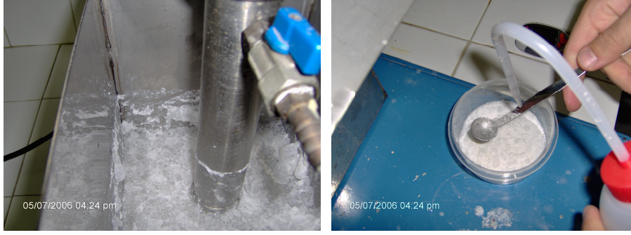
Şekil 3.4 Flotasyon makinesinde yüzdürülen konsantre materyal görünüşleri
