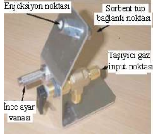
Şekil 4.16: Kalibrasyon çözeltisi yükleme rigi.
