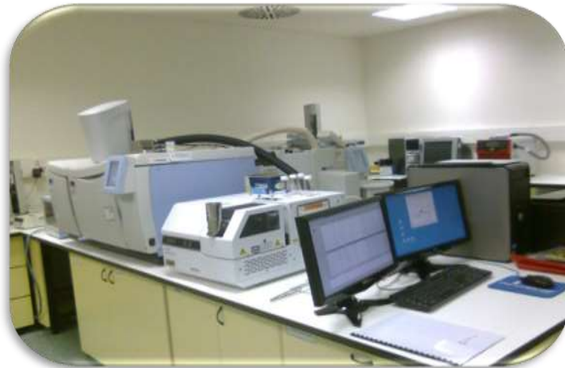
Şekil 2.2: Çalışmalar süresince analizde kullanılan TD-GC-MS sistemi (TÜBİTAK-UME, Gebze).
