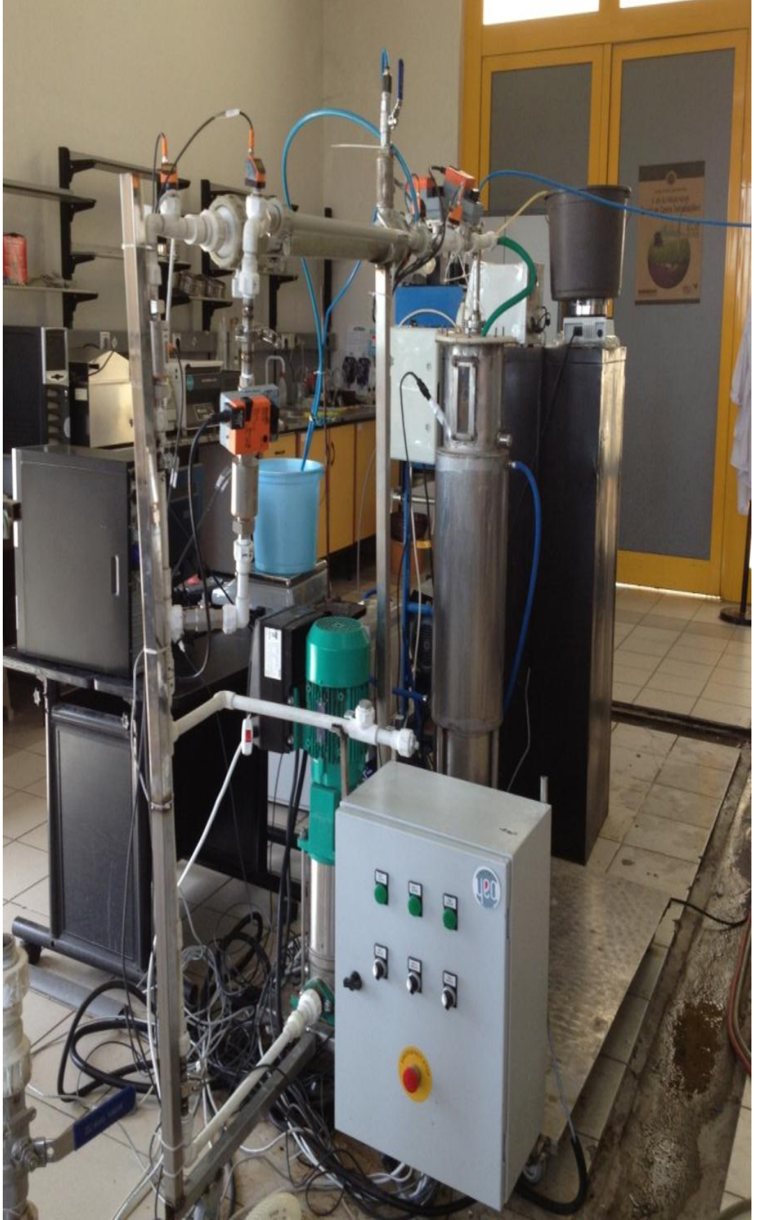
Şekil 3.2: Sürekli işletilen püskürtme çevrimli membran biyoreaktör.
