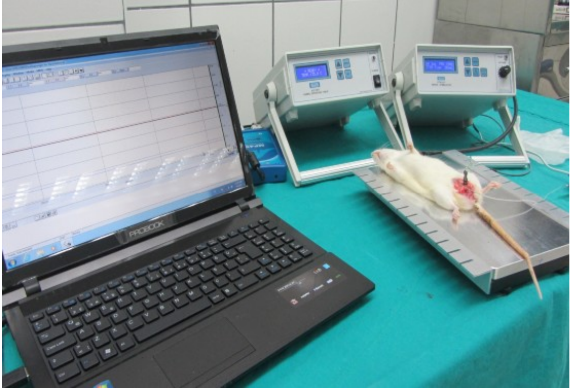
Resim 3: Penil kavernoza basinc ölçme sistemi ile veri toplama ünitesi.
