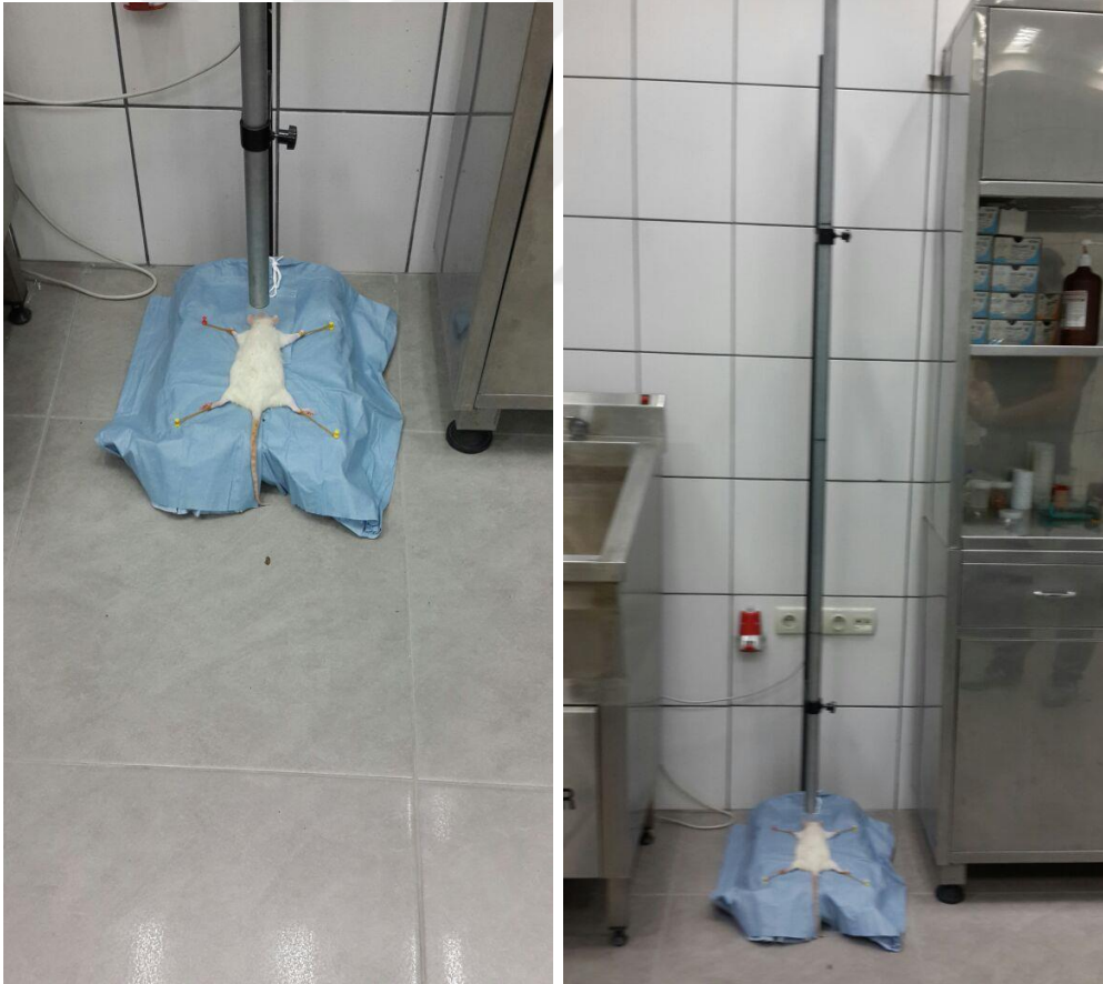
Resim 2( deneysel kafa travması modelinin modifiye edilerek, anestezi altındaki albino-wistar cinsi sıçanın kafa travması oluşturulacak şekilde düzeneğe yerleştirilmesi)
