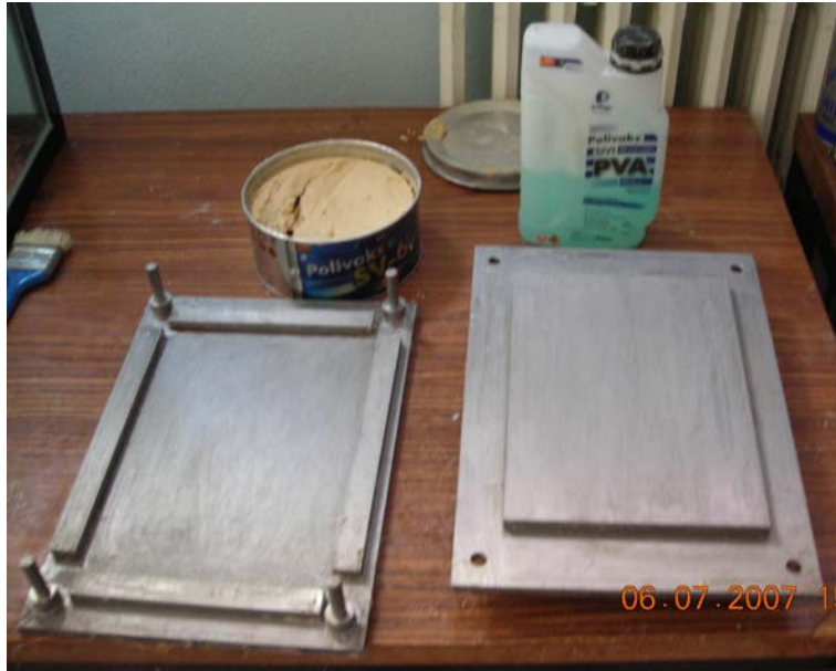
Şekil 5.5 Kalıba, Polivaks ve Polivaks EKO sıvı kalıp ayırıcı uygulanması
