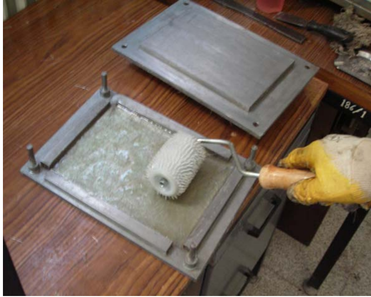
Şekil 5.7 Reçine emdirilmiş cam keçenin rulolanması
