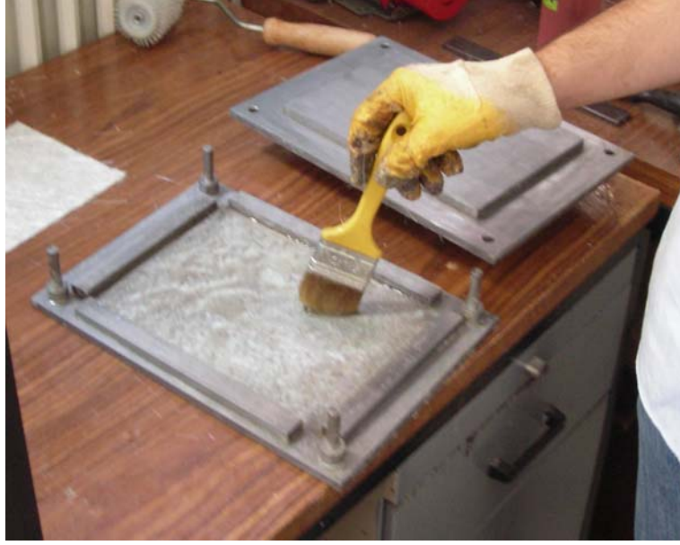
Şekil 5.6 Fırça yardımıyla cam keçeye reçine emdirilmesi
