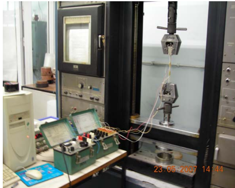
Şekil 5.11 E_1 ve \nu_{12} 'nin deneysel olarak bulunması
