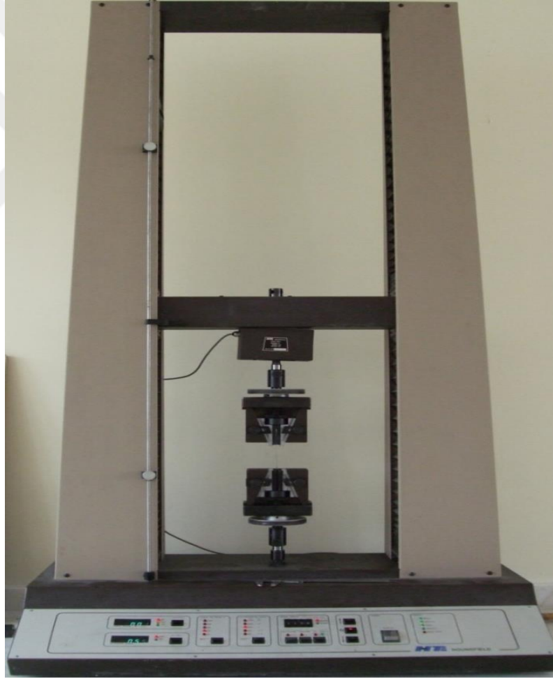
Resim 18: Biyomekanik testin yapıldığı üç nokta bükme makinesi
