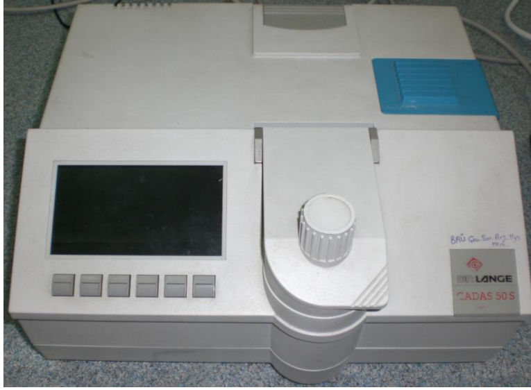
Şekil 2.3 Dr Lange CADAS 50S marka spektrofotometre ve Lange LCK 307 bor kiti
