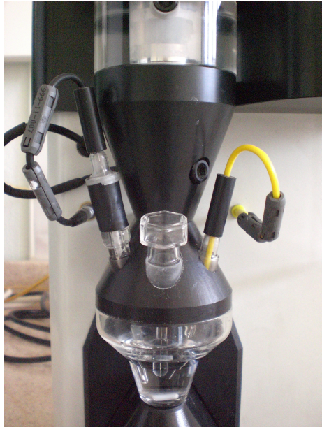
Şekil 2.2 Üçlü elektrot sistemi ve voltammetrik hücre
