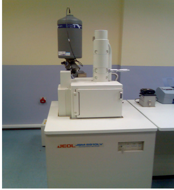
Şekil 2.1.2.2 Boncuk fotoğraflarının çekiminin yapıldığı Scanning Elektron Mikroskobu(SEM)
