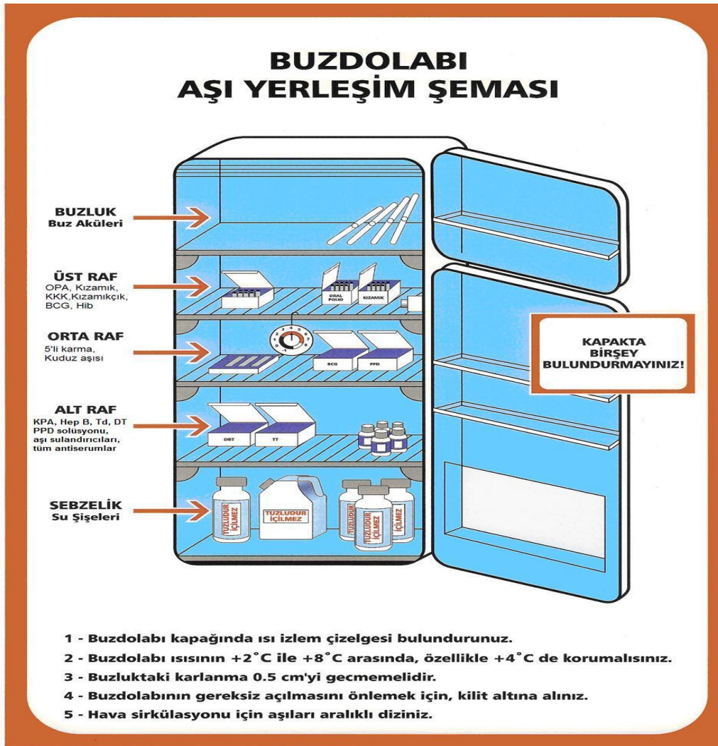
Şekil 2.4. Üstten Soğutmalı Buzdolabına Aşı Yerleşim Şeması(GBP, 2009).
