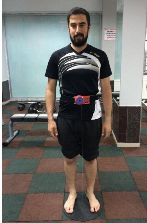
Şekil 22. Jumpmetre cihazı ile yapılan ölçümde başlangıç pozisyonu
