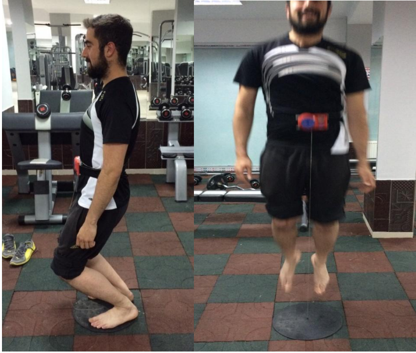
Şekil 23. Jumpmetre cihazı ile yapılan ölçümde dikey sıçrama hareketi
