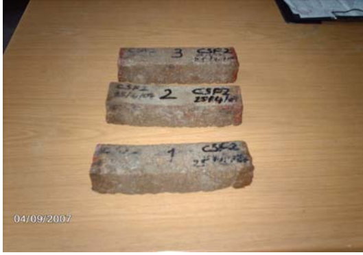
Şekil D.1 Magnezyum sülfat etkisinde hasar görmüş harçlar
