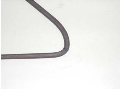
Şekil 4.28 Bükülmüş demir çubuk.
