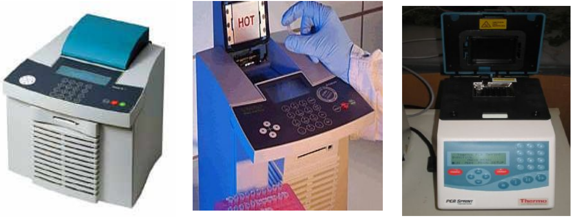
Resim 3.4: PZR’de kullanılan termocycle
