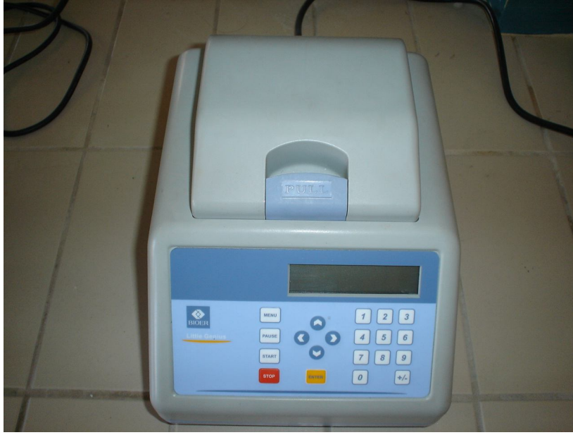
Şekil 3.3. Isıl döngü işlemlerinin gerçekleştirildiği “Thermal cycler” cihazı
