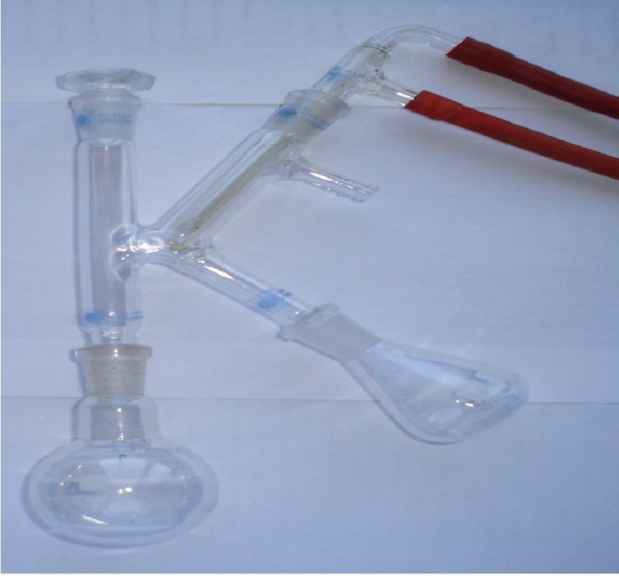
Şekil 3.2. Esterleşme reaksiyonlarında kullanılan K düzenegi
