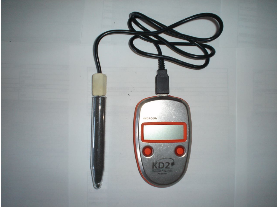
Şekil 3.4 Isıl iletkenlik ölçümleri için kullanılan ısıl iletkenlik ölçüm cihazı
