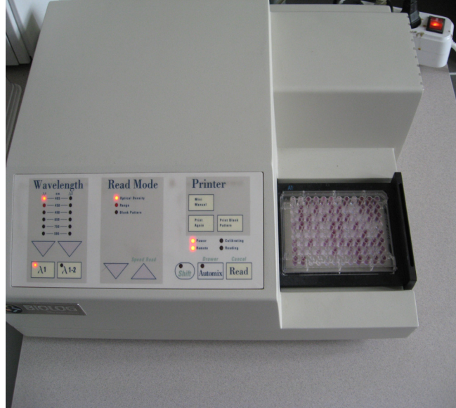
Şekil 3.9. İnkübasyon sonrası mikroplateler üzerinde gelişen metabolik reaksiyonun renklenme şeklinde görülmesi ve mikroorganizmaların metabolik reaksiyon profillerinin okunması için sisteme yerleştirilmesi
