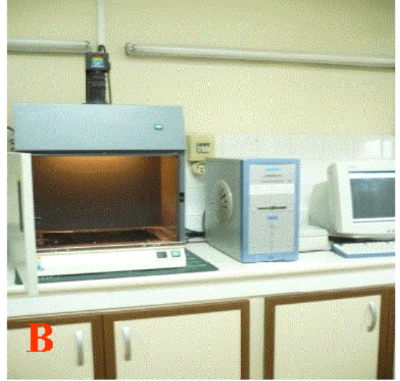
Şekil 3.12. Gram pozitif bulunan bakteri izolatlarının PCR amplifikasyonundan sonra %1,5 lik agaroz jelde koşturulması (A); Koşturulan agaroz jelin ethidium bromid ile boyandıktan sonra jel dökümantasyon sisteminde görüntülenmesi ve analizleri (B).
