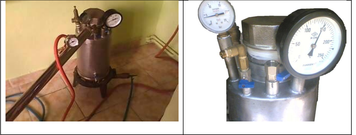
Şekil 4. 4. Yapılan güvenlik testinde basınçlı ekstraksiyon sisteminde sıcaklık 150 °C'ye ve basınç 5 bara kadar çıkılmaktadır
