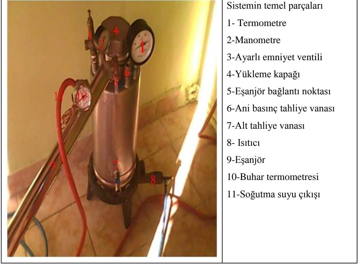
Şekil 4. 3. Yapılan basınçlı ekstraksiyon sistemi
