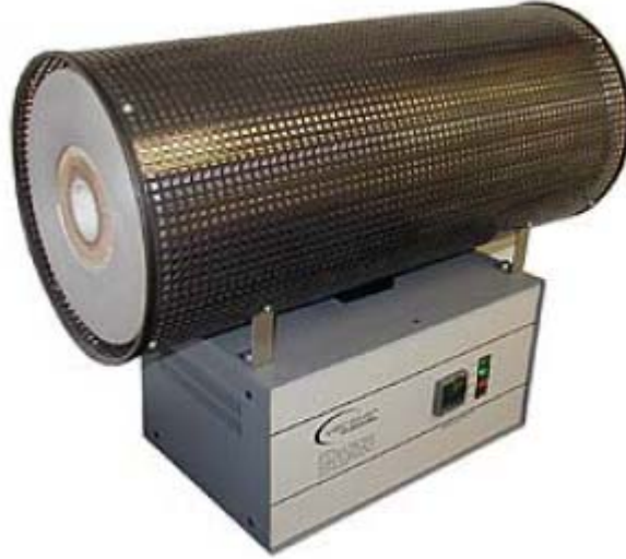
Őekil 3.2. Isıl iřlemlerde kullanılan 0-1200  C Vecstar VCTF-4 dif zyon fırını.
