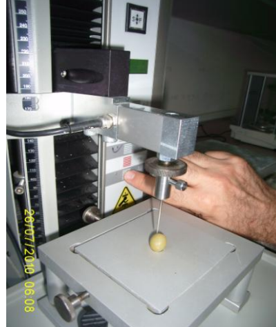
Şekil 3.5. Biyolojik materyal test cihazında üzümde sertliklerinin ölçülmesi
